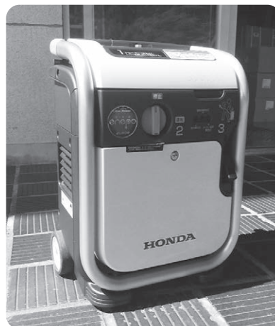
非常用発電機
